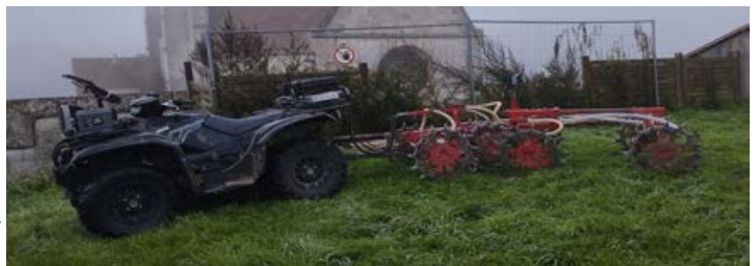
Figure 3 : Méthode ARP, radar de sol (Berrier©)
